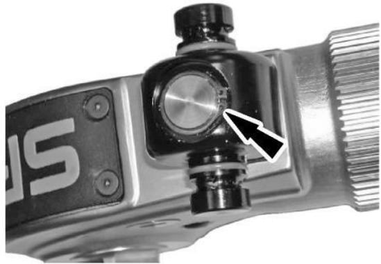
**Abbildung 14 Entfernen des Federrings Gelenkstück**
