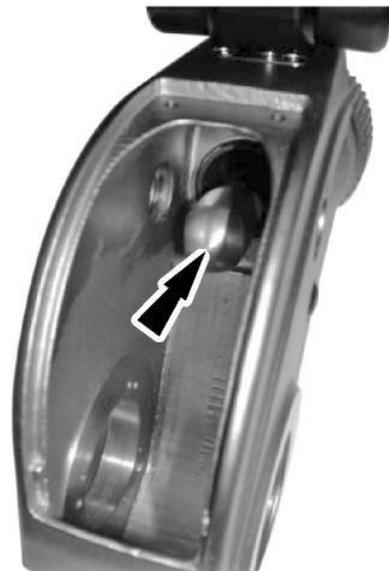
**Abbildung 20 Entfernen des Kolbens**
