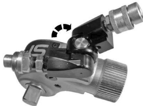
**Abbildung 12 Lösen des Anschlussstücks**
