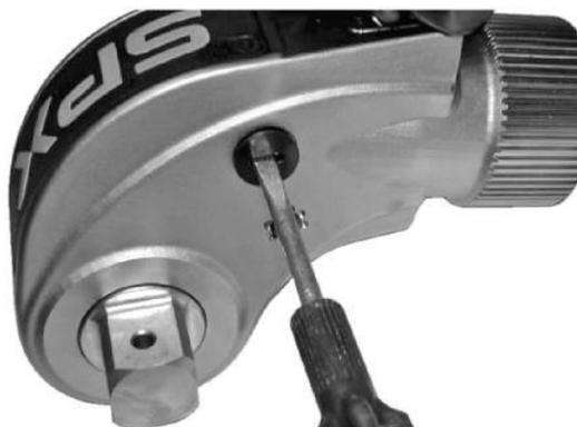
**Abbildung 5. Entfernen der Verschlussstopfen**
