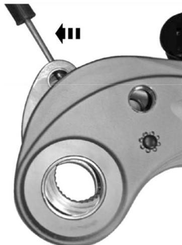
**Abbildung 8. Entfernen der Antriebseinheit**
