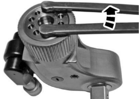
**Abbildung 19 Entfernen des Kolbenverschlusses**
