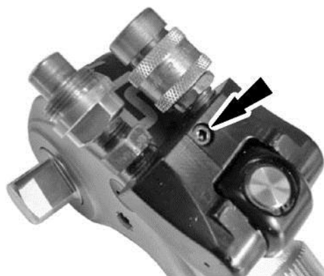
Рис. 11. Удаление винта хомута головки
