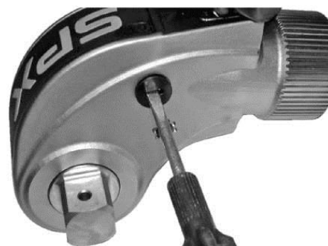
Рис. 5. Удаление заглушки корпуса
