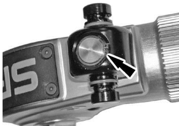
Рис. 14. Удаление пружинного кольца банджо
