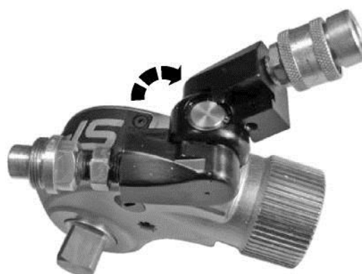
Рис. 12. Расцепление хомута головки
