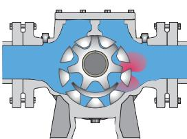
转子和惰轮啮合，液体被推送到出料管线。
