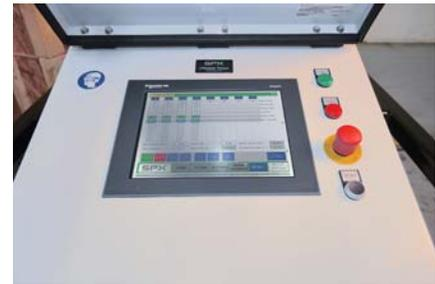
Der Home-Bildschirm des MCS ist übersichtlich und einfach zu bedienen. Alle aktive Komponenten werden visuell hervorgehoben. Für alle betätigten Zylinder wird die Hubleistung auf dem Bildschirm erfasst und angezeigt.
