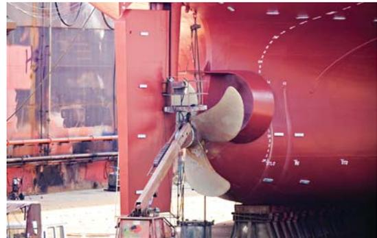
Bild oben: Rudermontage zur Routinewartung in einem Trockendock.
