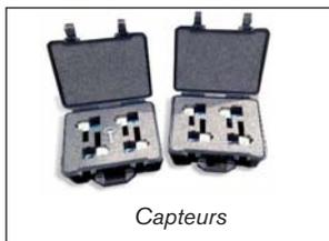
Les capteurs linéaires de positionnement ont une plage de 500mm. Ils sont livrés dans 2 valises de 4 capteurs. Se référer au tableau pour commander l'option de capteurs de 1000mm
