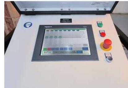
L'écran d'accueil sur le système de contrôle de mouvement est facile à utiliser et à exploiter. Il met en évidence toutes les activités pendant l'utilisation du système de contrôle de mouvement. Pour chaque vérin en fonctionnement, la performance des vérins est enregistrée et affichée sur l'écran IHM, comme illustré ci-dessous.
