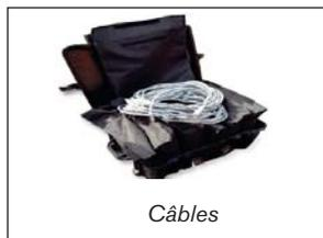
Les câbles des capteurs de pression sont de 30,5mètres, par 8 ensembles dans un coffret en plastique dur.
