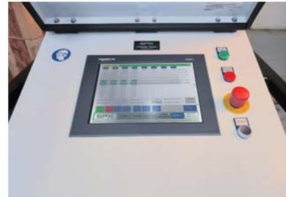
La schermata iniziale del sistema di controllo del moto è altamente intuitiva e semplice da utilizzare. Mette in evidenza tutte le attività durante l'uso del sistema di controllo del moto. Il sistema rileva le prestazioni di ogni cilindro in funzione e le mostra sullo schermo IUM, come illustrato di seguito.
